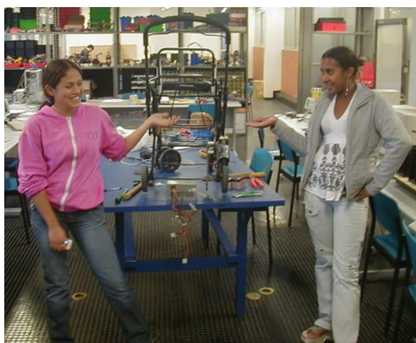
Figura 5. O carrinho de bebê que detecta o choro do bebê automaticamente e balança o carrinho até ele parar de chorar, idealizado e construído por Jaíne e sua colaboradora.
